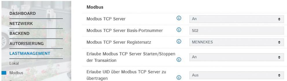
Abb. 30: Weboberfläche zur Konfiguration von Modbus TCP
