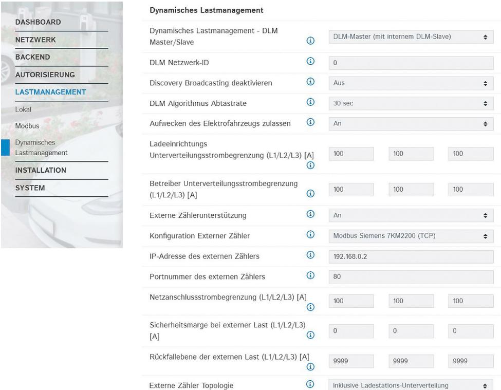
Abb. 29: Weboberfläche des DLM-Masters zur Konfiguration von Lastmanagement
