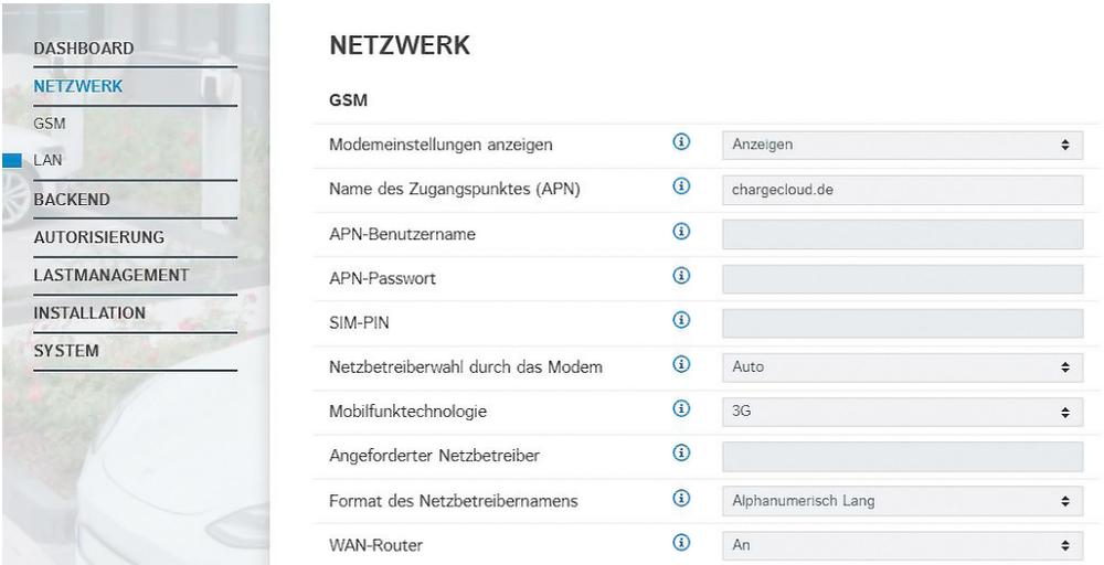
Abb. 14: Weboberfläche des Gateway-Ladepunkts zur Konfiguration des Gateway-Ladepunkts
