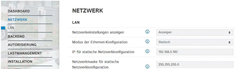
Abb. 12: Weboberfläche zur Konfiguration von statischen IP-Adressen
