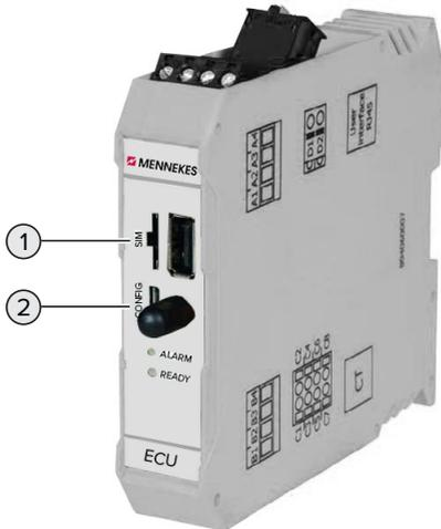
Abb. 1: Anschlüsse auf der ECU
