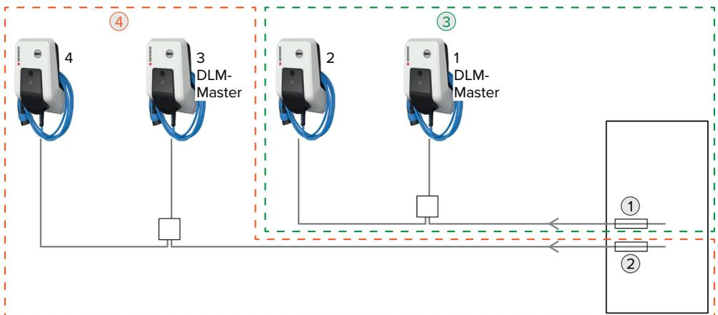
Abb. 22: Lastmanagement bei einem Parkplatz mit mehreren Ladestationen und einem gemeinsamen Netzanschluss (Beispiel: Produkte mit integrierten Fehlerstromschutzschalter und Leitungsschutzschalter)
