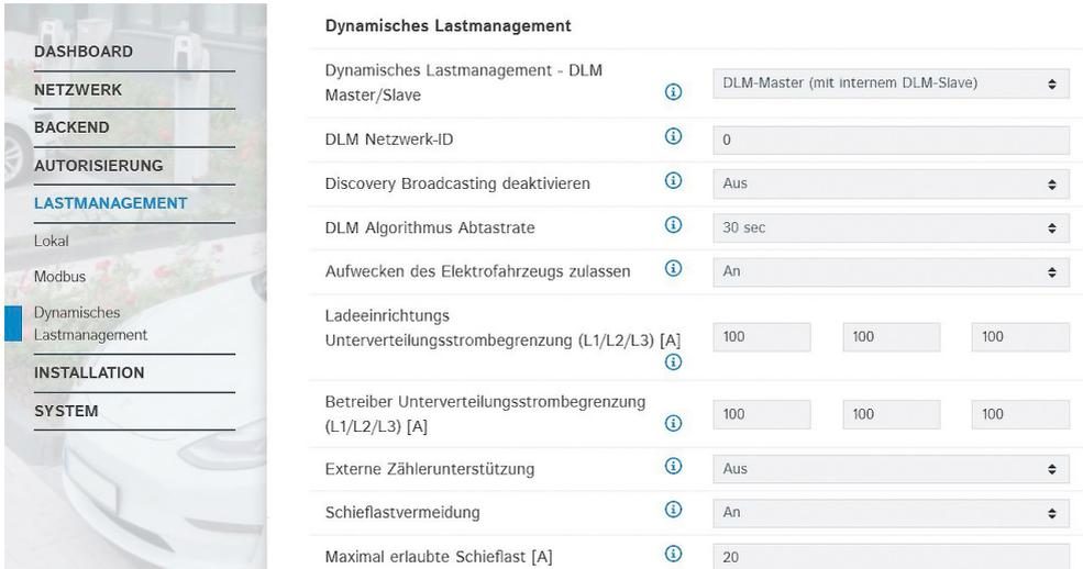
Abb. 33: Weboberfläche des DLM-Masters zur Konfiguration von Schieflastvermeidung
