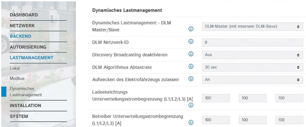
Abb. 23: Weboberfläche des DLM-Masters zur Konfiguration von Lastmanagement
